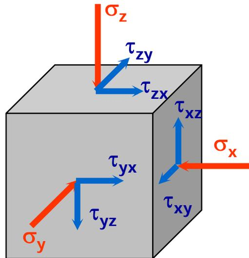
Note le componenti speciali di tensione nel generico riferimento  $x, y, z$ , è possibile ottenere le componenti di tensione agenti sul generico piano di normale  $\underline{n}$ , attraverso le relazioni:
