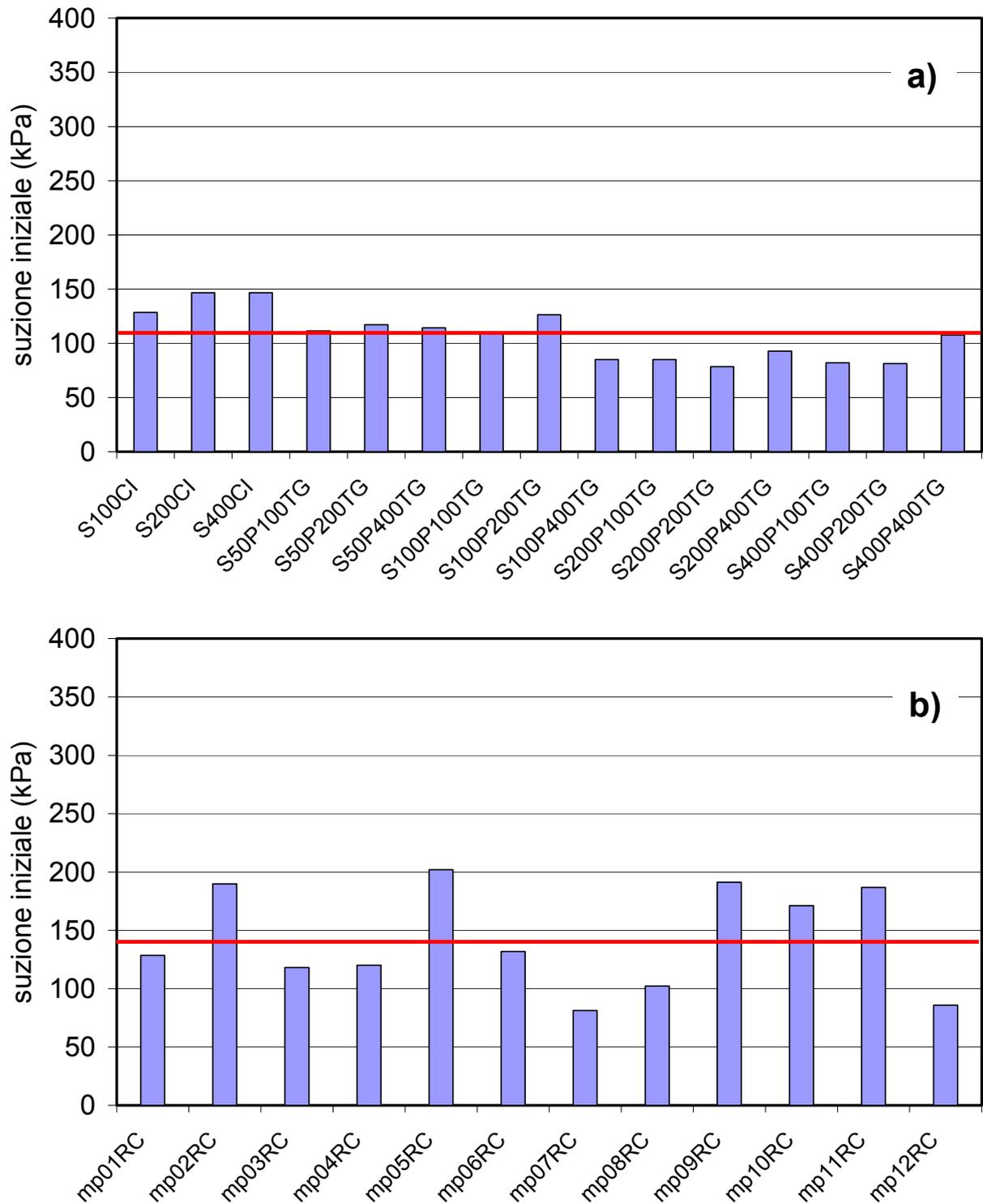
**Figura V.1:** Suzioni indotte dal costipamento sui provini testati: (a) in cella triassiale; (b) in cella di colonna risonante.
