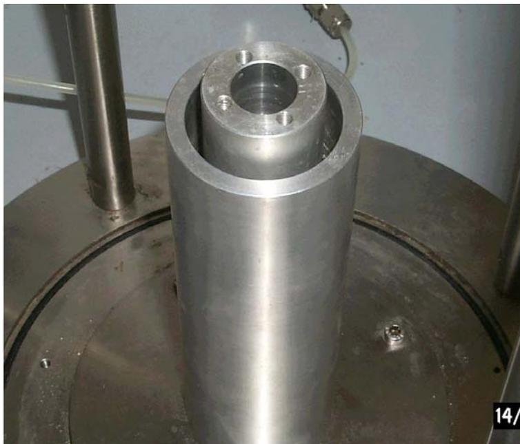
**Figura III.28:** Bicchiere di misura delle deformazioni radiali.
