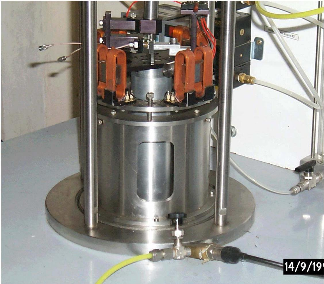
**Figura III.26:** Motore elettro-magnetico per l'applicazione delle sollecitazioni torsionali.
