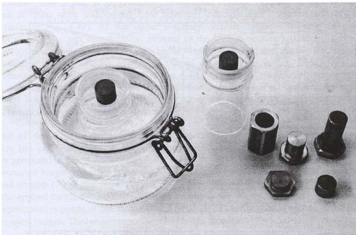
**Figura III.10:** Sistema per l'applicazione della suzione con la tecnica di controllo ambientale (Romero, 1999).
