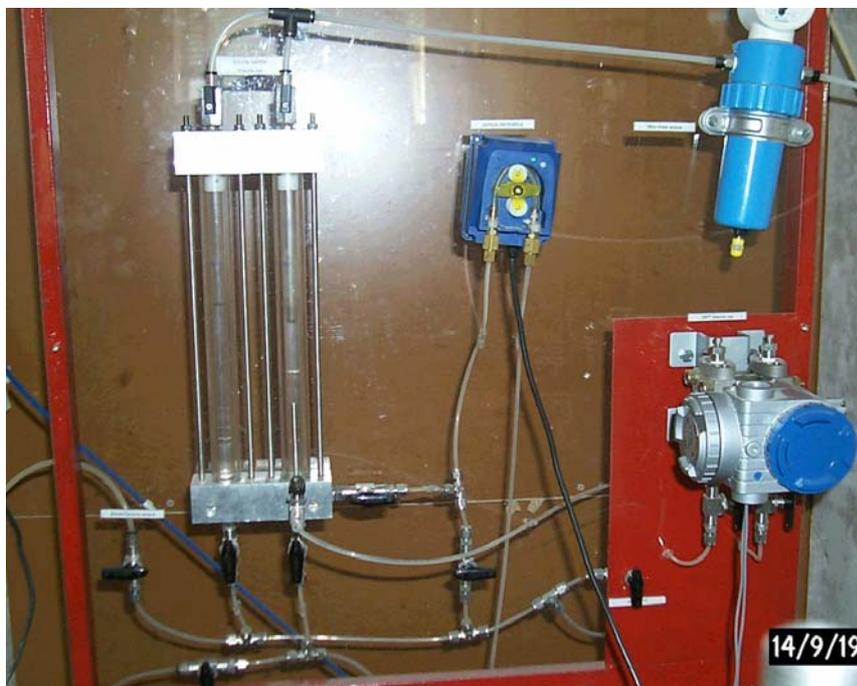
**Figura III.31:** Sistema di misura delle variazioni di contenuto d'acqua.
