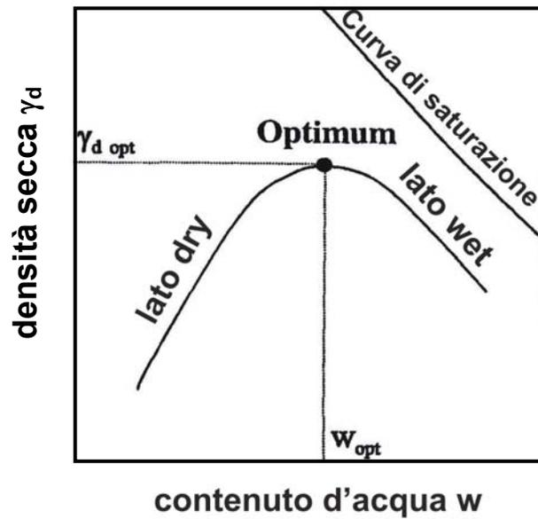
Figura II.1: Rappresentazione schematica della curva di costipamento.
