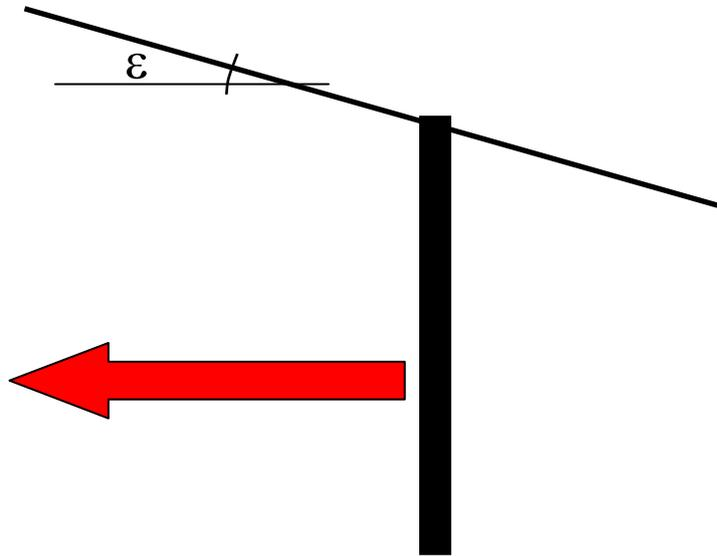
Si può procedere in modo analogo per il caso della resistenza passiva, ossia della condizione di rottura raggiunta per effetto di un aumento di tensioni orizzontali. Il punto P nel piano di Mohr è lo stesso, mentre il cerchio a rottura è l'altro cerchio compatibile con il passaggio per P e con la condizione di tangenza.
