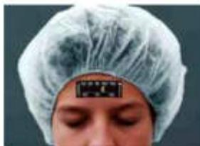
Sono termometri a cristalli liquidi di ridotte dimensioni dove la barretta colorata scema mostrando la temperatura. Sono leggermente autoadesivi e si posizionano sulla fronte del paziente. Calibrati per la temperatura interna. Non c'è presenza di lattice. Facili e pratici da usare anche come monouso.
