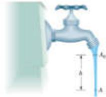
**figura 15.18** Problema svolto 15.7. Quando l'acqua esce da un rubinetto la sua velocità aumenta. Giacché la portata deve essere la stessa in tutte le sezioni attraversate, il getto deve restringersi.
