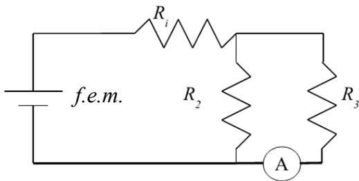
10) Un generatore con *f.e.m.*  $=12 \text{ V}$  e resistenza interna  $R_i=100 \Omega$  viene collegato a due resistenze  $R_1=12 \text{ k}\Omega$  e  $R_2=1.7 \text{ k}\Omega$ , come in figura. Calcolare la corrente che attraversa  $R_2$  e la potenza dissipata da  $R_1$  e da  $R_2$ .
