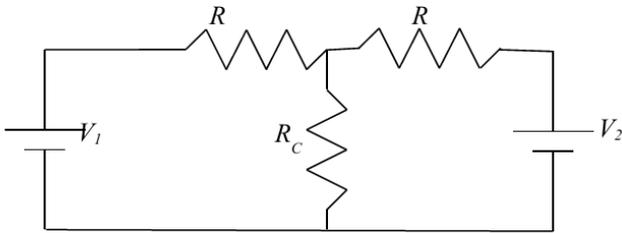
8) Per riscaldare un recipiente si utilizza una resistenza  $R$  collegata come in figura. Disegnare l'andamento della potenza dissipata da  $R$  in funzione di  $R$  stessa. Calcolare il valore di  $R$  che fornisce il massimo riscaldamento. ( $R_1=15 \Omega$ ,  $R_2=300 \Omega$ ,  $V=220 \text{ Volt}$ )
