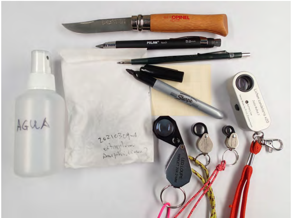
Figura 10.- Algunas de las herramientas imprescindibles para estudiar briófitos en el campo: navaja con seguro (las mías Opinel n.º 8 inox.), portaminas (de 5,2 y 2 mm), rotulador permanente de tinta negra, pulverizador de agua, sobres de papel, papel milimetrado plastificado y lupa de campo (de izquierda a derecha, lupa x20 de Euromex, de x14 y x20 de Bausch & Lomb y una Lichen candelaris x20, fabricada por Erich Zimmermann).
