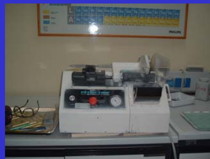
Retrotaglio e abbassamento della lamina di roccia (Buehler Petrothin)
