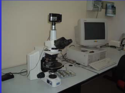
Microscopio a luce polarizzata Nikon Eclipse E600 Pol con camera digitale e sistema di acquisizione ed elaborazione delle immagini.
