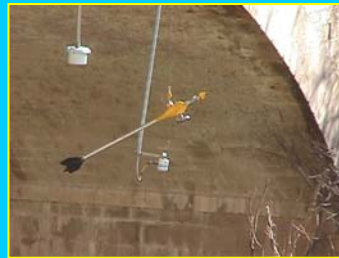
rilevo svolto da ponte con sistema di calata: carrello, peso idrodinamico
