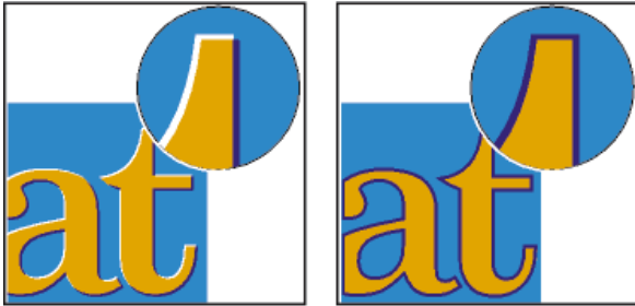
Messa a registro errata senza trapping (sinistra) e con trapping (destra)
