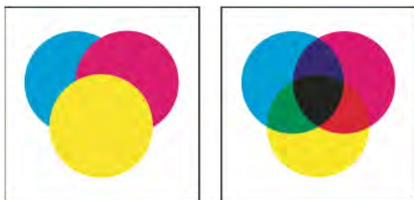
Tre cerchi sovrapposti senza sovrastampa (a sinistra) e con sovrastampa (a destra)
