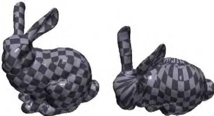
Texture riparametrizzata con Distorsione bassa (a sinistra) e Meno giunture (a destra)
