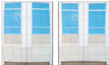
Esempi di distorsione a barile (a sinistra) e distorsione a cuscinetto (a destra)
