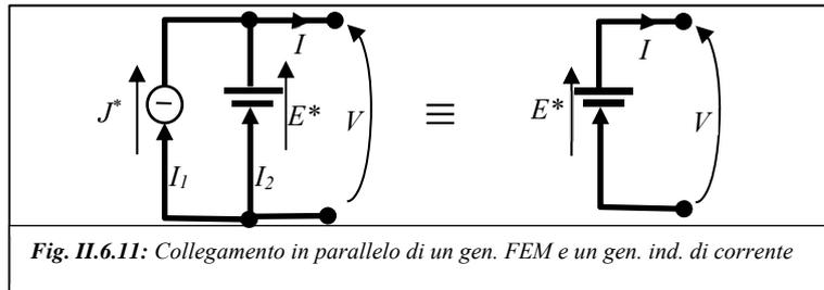
Il parallelo di un generatore indipendente di tensione che impone la FEM  $E^*$  e di un generatore indipendente di corrente che imprime la corrente  $J^*$  è equivalente ad un generatore di tensione che impone la stessa FEM imposta dal generatore di tensione originario,  $E^*$ . Si noti che la corrente  $I_{E^*eq}$ , che attraversa il generatore equivalente di tensione, non è uguale alla corrente  $I_{E^*}$ , che attraversava il generatore di tensione originario:
