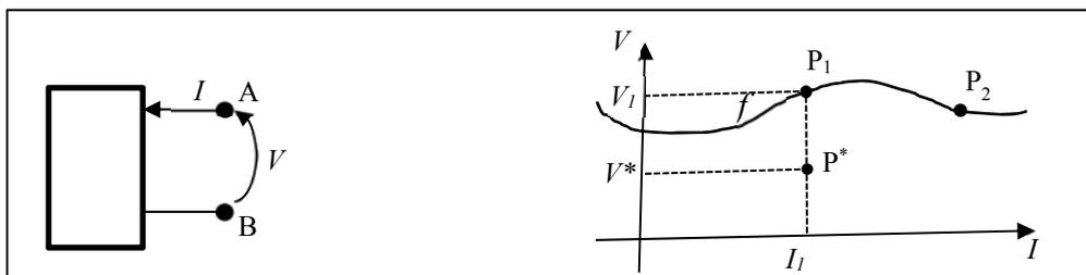
Fig. II.3.1: Caratteristica di un bipolo: il punto  $P^*$ , esterno alla caratteristica, non è un punto di lavoro ammissibile. I punti  $P_1$  e  $P_2$ , giacendo sulla curva caratteristica, sono entrambi punti di lavoro ammissibili per il bipolo
