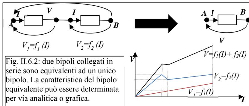
Fig. II.6.2: due bipoli collegati in serie sono equivalenti ad un unico bipolo. La caratteristica del bipolo equivalente può essere determinata per via analitica o grafica.
