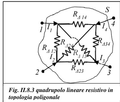
Fig. II.8.3 quadrupolo lineare resistivo in topologia poligonale
