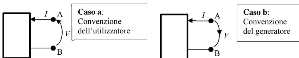
Fig. II.2.3 Convenzione dell'utilizzatore e del generatore per il bipolo
