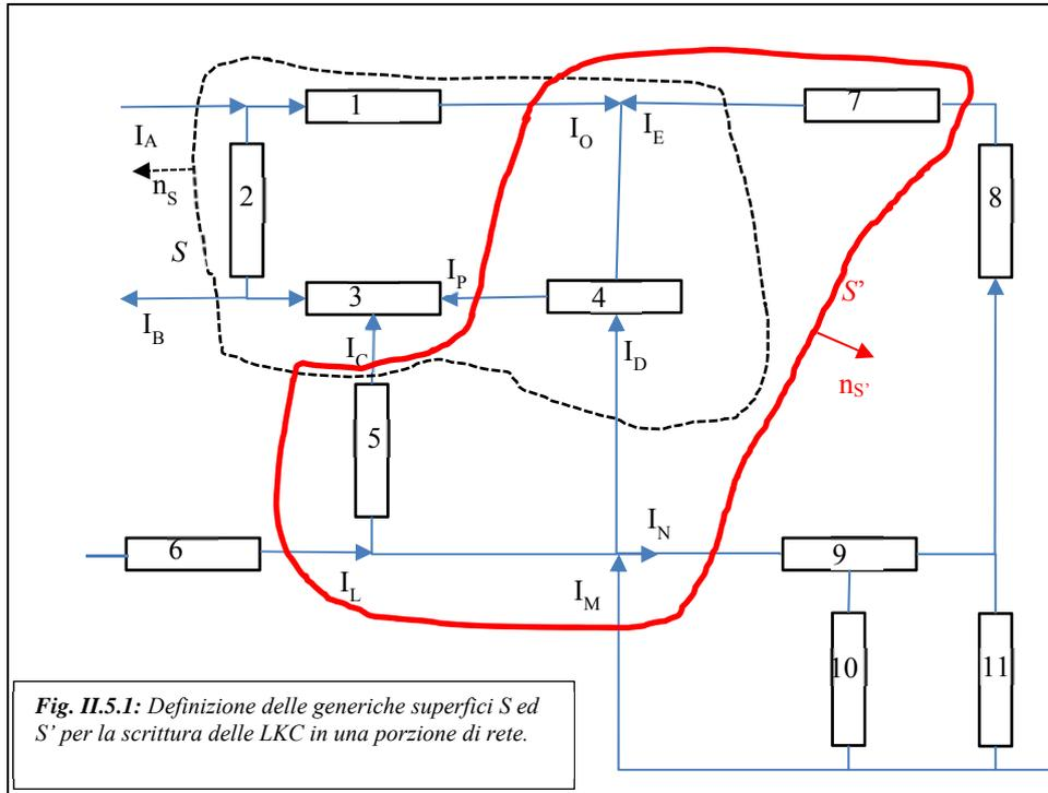
**Fig. II.5.1:** Definizione delle generiche superfici  $S$  ed  $S'$  per la scrittura delle LKC in una porzione di rete.
