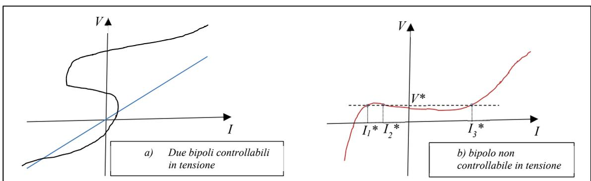
**Fig. II.3.3e:** Classificazione dei bipoli: a) due esempi di bipoli controllabili in tensione; b) bipolo non controllabile in tensione: in corrispondenza della tensione  $V^*$  vi sono tre diverse correnti ammissibili ( $I_1^*$ ,  $I_2^*$  e  $I_3^*$ )
