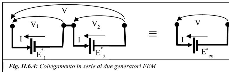
Due generatori ind. di tensione la cui FEM è pari rispettivamente a  $E_1^*$  e  $E_2^*$  sono equivalenti ad unico generatore la cui FEM risulta pari a  $E_{eq}^* = E_1^* + E_2^*$ . Si noti che ove le FEM dei singoli generatori siano orientate in senso discorde la somma va intesa in senso algebrico. Anche in questo caso è valida ed intuitiva l'estensione al caso di N-generatori indipendenti di tensione collegati in serie.
