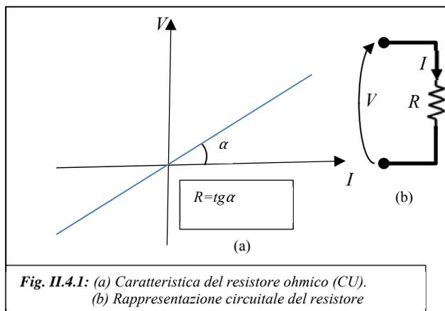
**Fig. II.4.1:** (a) Caratteristica del resistore ohmico (CU). (b) Rappresentazione circuitale del resistore
