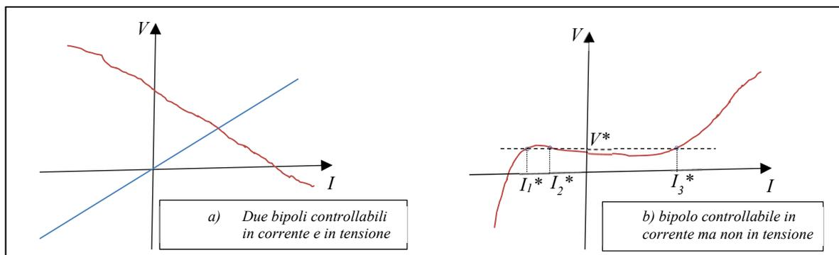
**Fig. II.3.3f:** Classificazione dei bipoli: a) due esempi di bipoli controllabili sia in tensione che in corrente: la loro curva caratteristica è invertibile; b) bipolo non monotono controllabile in corrente ma non in tensione: in questo caso la caratteristica non è invertibile
