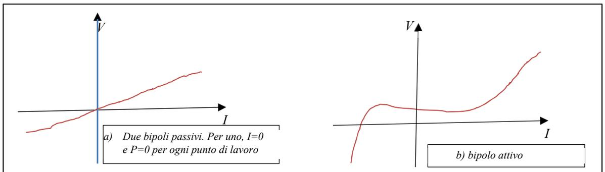
**Fig. II.3.3g:** Classificazione dei bipoli: a) due esempi di bipoli passivi: si noti che la caratteristica di uno di questi coincide con l'asse delle ordinate ( $I=0$ ); b) bipolo attivo: una parte della caratteristica giace nel secondo quadrante.
