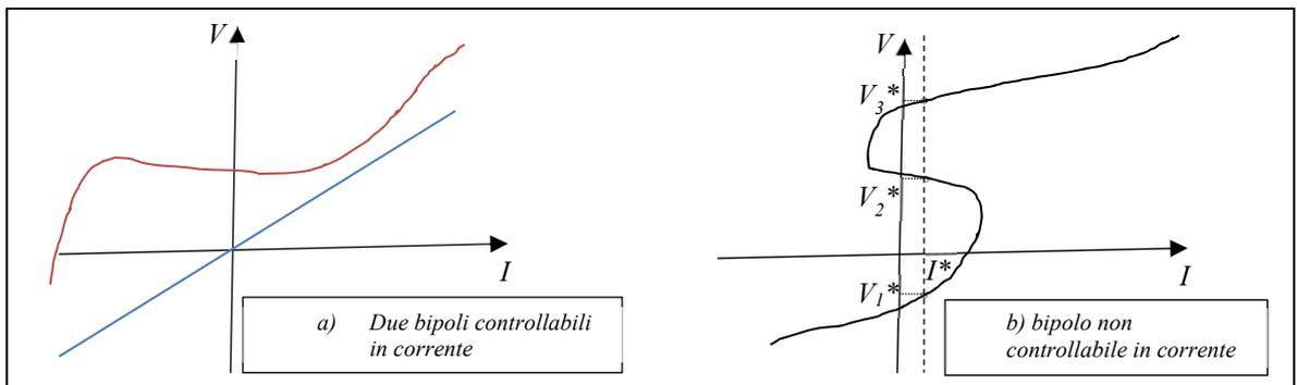
**Fig. II.3.3d:** Classificazione dei bipoli: a) due esempi di bipoli controllabili in corrente; b) bipolo non controllabile in corrente: in corrispondenza della corrente  $I^*$  vi sono tre diverse tensioni ammissibili ( $V_1^*$ ,  $V_2^*$  e  $V_3^*$ )
