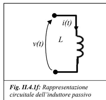
**Fig. II.4.1f:** Rappresentazione circuitale dell'induttore passivo
