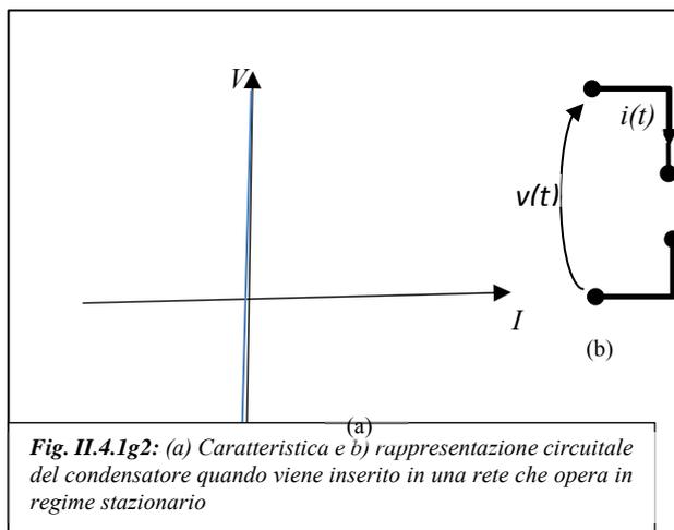
**Fig. II.4.1g2:** (a) Caratteristica e b) rappresentazione circuitale del condensatore quando viene inserito in una rete che opera in regime stazionario
