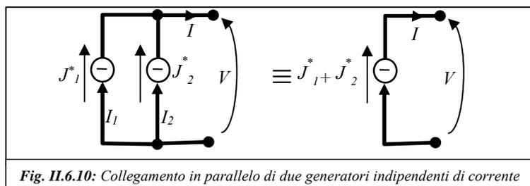
Fig. II.6.10: Collegamento in parallelo di due generatori indipendenti di corrente
