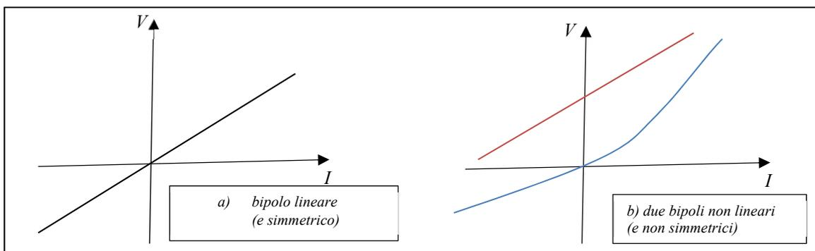
Fig. II.3.3c: Classificazione dei bipoli: a) bipolo lineare (e simmetrico); b) bipoli non lineari (e non simmetrici)
