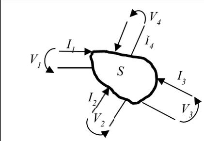
La Potenza elettrica totale assorbita dal tetra-bipolo in fig.II.2.6 viene calcolata come somma delle potenze elettriche assorbite alle quattro porte del componente:
