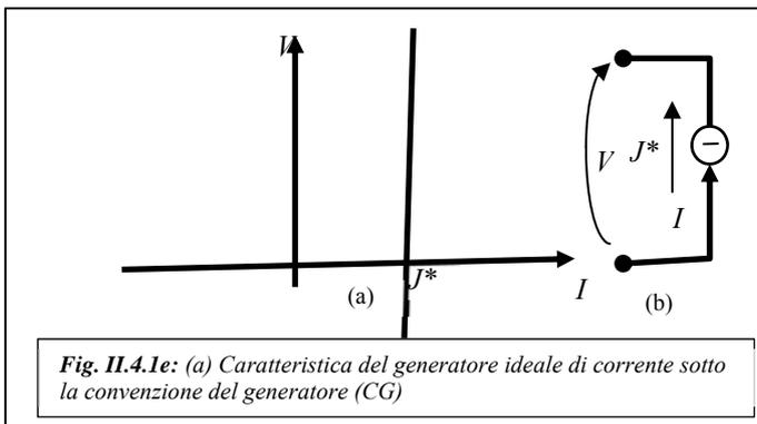
**Fig. II.4.1e:** (a) Caratteristica del generatore ideale di corrente sotto la convenzione del generatore (CG)
