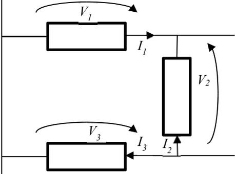
La Potenza elettrica totale assorbita dalla porzione di rete in fig.II.2.4 può essere calcolata come somma delle potenze elettriche assorbite dai singoli bipoli:
