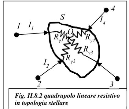
Fig. II.8.2 quadrupolo lineare resistivo in topologia stellare
