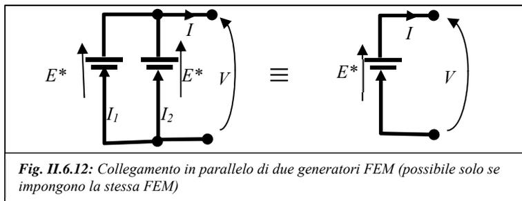
Nell'ambito della teoria dei circuiti a parametri concentrati non è generalmente possibile collegare in parallelo due generatori indipendenti di tensione che impongono rispettivamente le FEM  $E_1^*$  e  $E_2^*$ .
