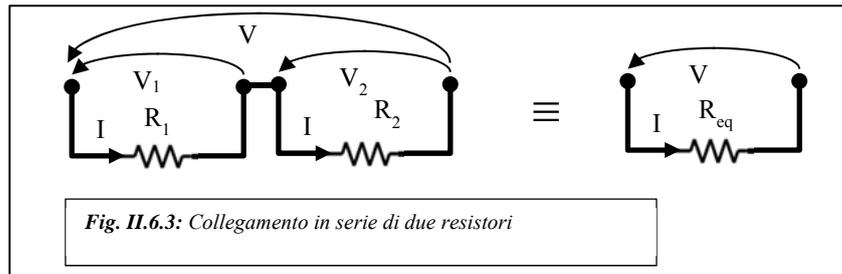
Due resistori di resistenza pari risp. a  $R_1$  e  $R_2$  collegati in serie sono equivalenti ad un resistore di resistenza  $R_{eq}=R_1+R_2$ .
