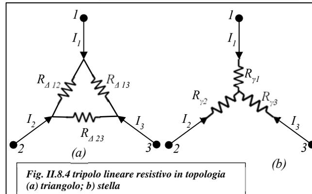
Fig. II.8.4 tripolo lineare resistivo in topologia (a) triangolo; b) stella
