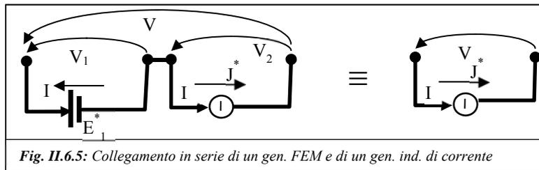
La serie di un generatore indipendente di tensione che impone la FEM  $E^*$  e di un generatore indipendente di corrente che impone la corrente  $J^*$  è equivalente ad un generatore di corrente che impone la corrente imposta dal generatore indipendente di corrente  $J^*$ . Si noti che la tensione  $V_{J^*eq}$ , che si misura ai capi del generatore equivalente di corrente, non è uguale alla tensione  $V_{J^*}$ , che insisteva ai capi del generatore di corrente originario:
