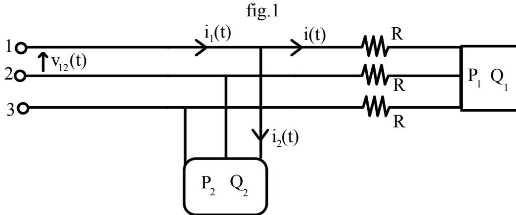
$i(t) = \sqrt{2} \cdot 10 \cdot \sin(314 t)$ ;  $R = 10 \Omega$ ;  $P_1 = P_2 = 2 \text{ kW}$ ;  $Q_1 = 2 \text{ kVA}_r$ ;  $Q_2 = -2 \text{ kVA}_r$ ;
