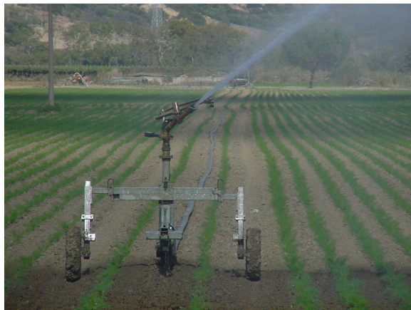
Fig. 11.14. — Esempio di impianto mobile di irrigazione a pioggia. La tubazione che porta gli irrigatori viene spostata da un appezzamento all'altro dopo ogni adacquata, mentre la condotta principale viene rimossa dopo aver irrigato un gruppo di appezzamenti, oppure soltanto a fine stagione.
