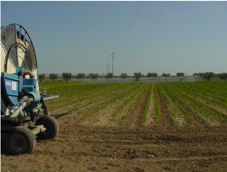
Fig. 42: Esempio di funzionamento di un irrigatore gigante mobile. In A il trattore svolge il tubo flessibile che poi sarà riavvolto dall'argano durante la bagnatura; successivamente, il trattore sposta la macchina in B dove ripete l'operazione sia a sinistra che a destra della capzagna.
